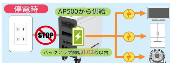
オフラインUPSモードでは通常時コンセントから直接家電に電気を送り同時に充電。停電時は0.02秒以内に自動で蓄電池から電気を供給します。
